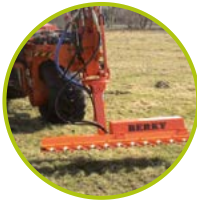
▲ Machine avec barre de coupe et andaineuse sur bras articulé, de la marque Berky.
